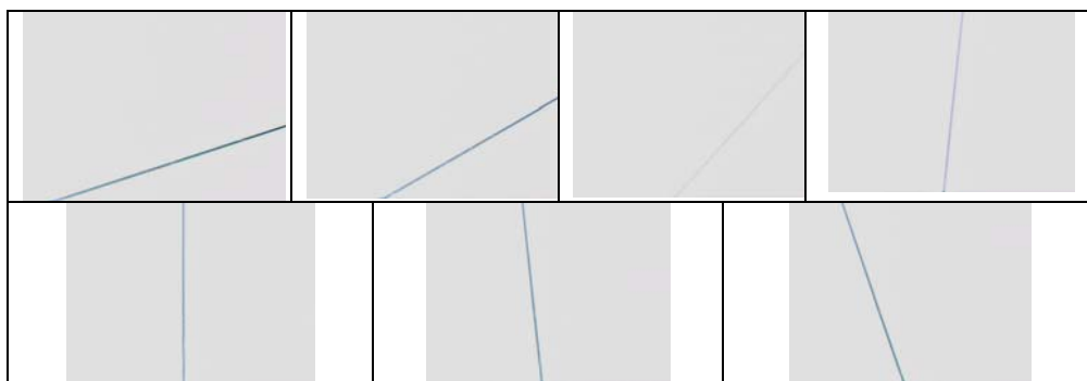
Rys.4 Negatywy zdjęć kapilary, wypełnionej 6CHBT i bez materiału orientującego, pod mikroskopem polaryzacyjnym przy skrzyżowanych polaryzatorach dla różnych pozycji kapilary względem osi polaryzatora
