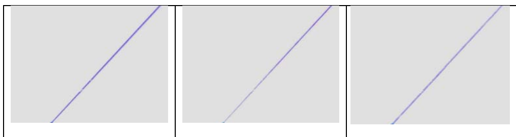
Rys.7 Negatywy zdjęć kapilary, wypełnionej 6CHBT i z materiałem orientującym CelCi orientującym planarnie, pod mikroskopem polaryzacyjnym przy skrzyżowanych polaryzatorach dla różnych pozycji kapilary względem osi polaryzatora
