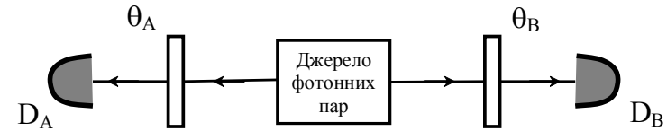
Рис. 25. Джерело генерує світло у двофотонному синглетному стані. Два фотони із взаємно перпендикулярними поляризаціями поширюються в протилежних напрямках A та B . Буквами \theta та D позначено відповідно поляризатори та детектори фотонів
