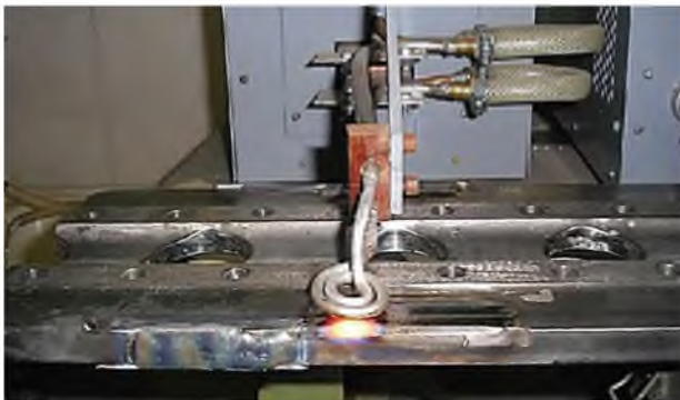
Установка для індукційної швидкої термообробки титанової продукції
