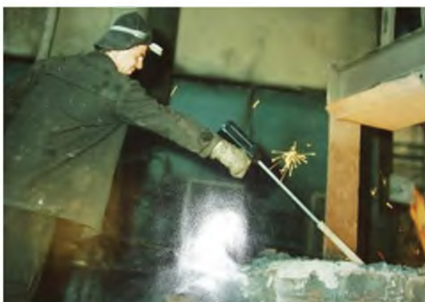
Промислове застосування термометрів типу ТПЦ-К
