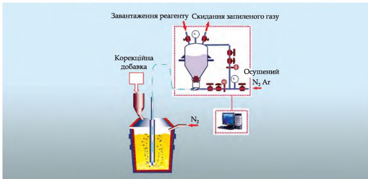
Схема процесу десульфурації чавуну
