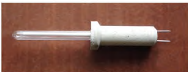
Термоелектричний змінний перетворювач занурення типу ТЗП-Ш
