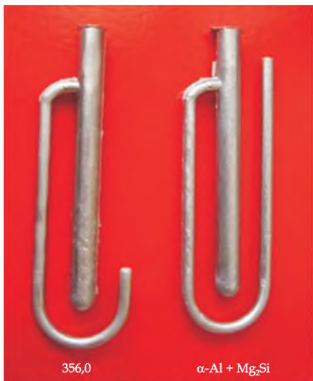
Рідкоплинність промислового ливарного 356,0 (USA) та ( \alpha -Al + Mg 2 Si) сплавів
