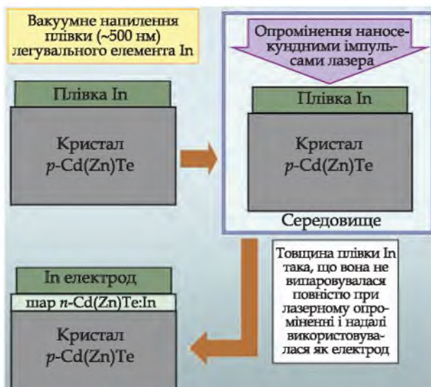
Схема технологічних процесів лазерно-індукованого твердофазного легування наночару кристала p\text{-Cd(Zn)Te} домішкою In та формування p\text{-n} -переходу
