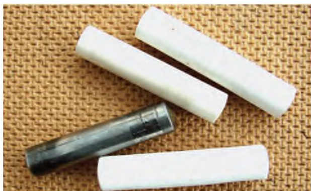
Керамічні плунжери маслостанції СНТ-32
