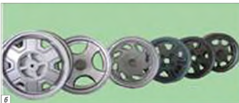
Комплект деталей гідромуфти (а) та колеса легкових автомобілів (б), отримані литтям під низьким тиском на машині АЛУГ-3
