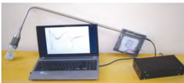
Установка типу УТГЕА-Ч для термографічного експрес-аналізу чавуну
