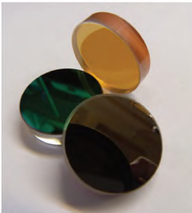
Зразки покриттів на кварцових підкладках, отримані з матеріалів систем: Ge — ZnS (коричневий колір); Ge — ZnO (помаранчевий колір); високочистий ZnS / Cr (зелено-блакитний колір)
