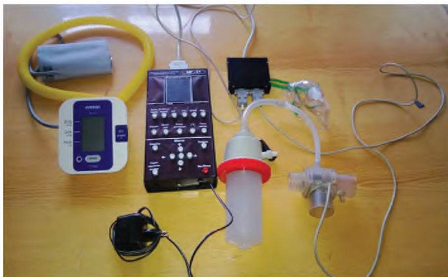
Монітор рятівника отруєних чадним газом — загальний вигляд (ліворуч) та вимірювальний блок (праворуч)
