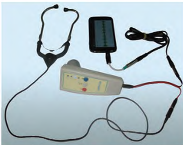
Електронний стетоскоп ЕФОН-08 у спряженні зі смартфоном
