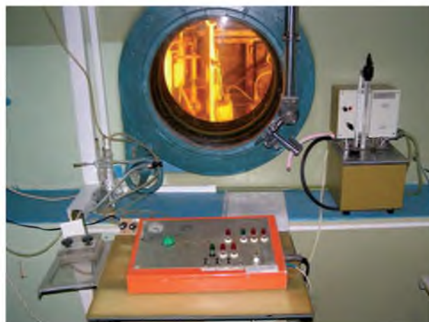
Гаряча камера стаціонарного екстракційного генератора 99mTc
