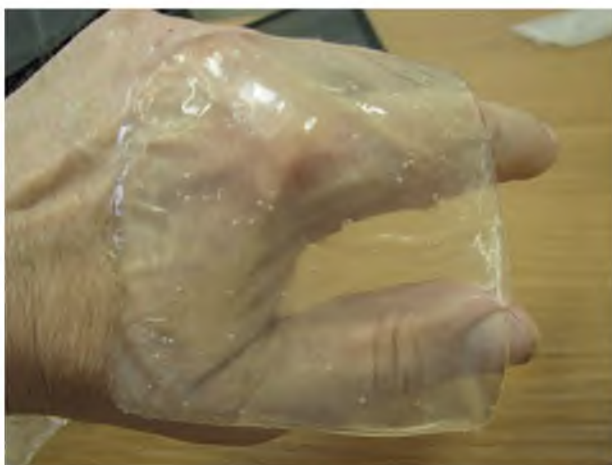
Пружна деформація лікувальної пов'язки до розриву становить 50–100 %
