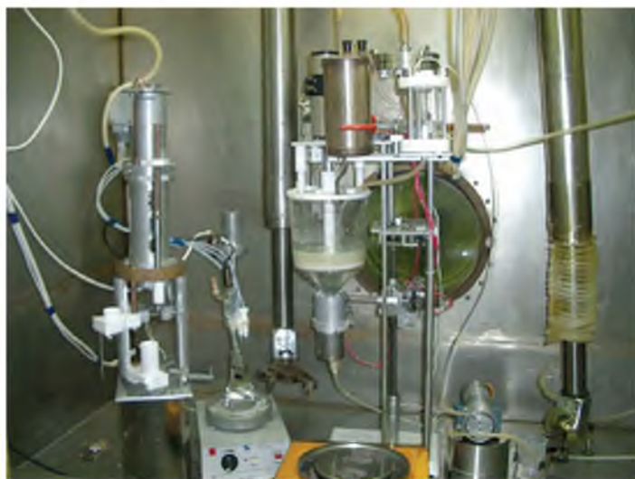
Установка для синтезу гелю Mo-Zr
