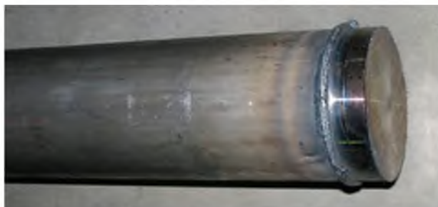
Корпус гідроциліндра, \varnothing 110 \times 7,5 мм
