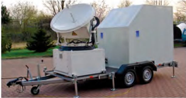
Метеорадар зі сканувальною антеною
