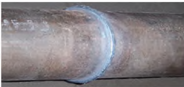
Зварне з'єднання, труба \varnothing 120 \times 7 мм
