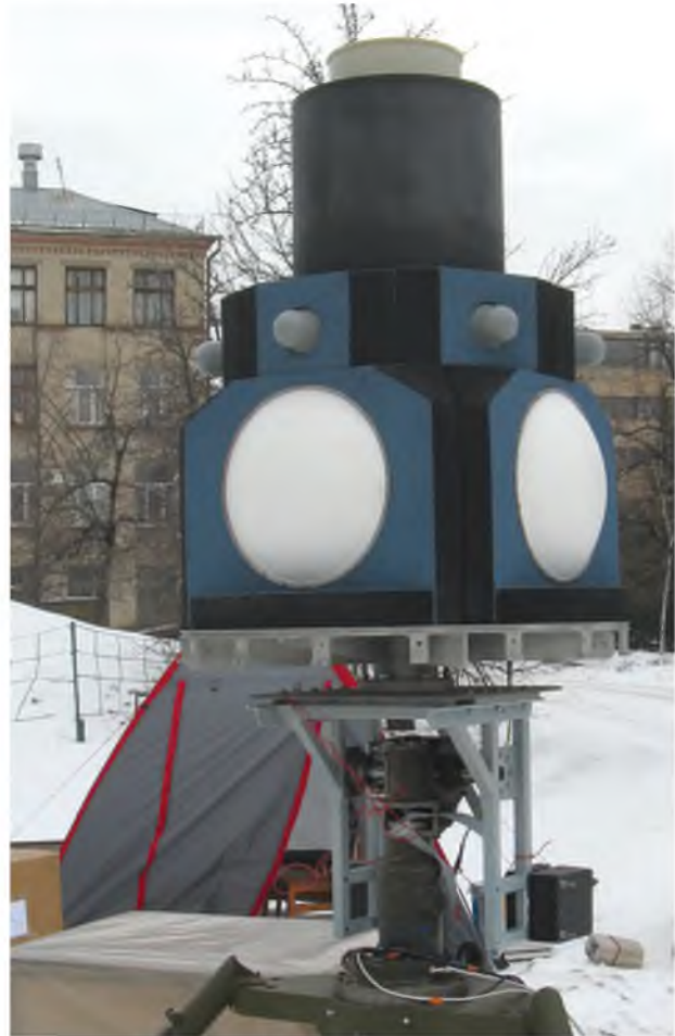
Широкопasmовою антенна система кругового огляду (0,4–18 ГГц)
