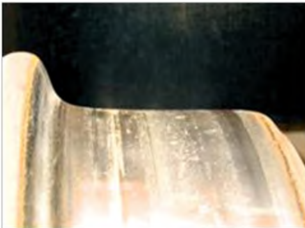
Плями контакту на колесах зі стандартним профілем (а) і з профілем ІТМ-72-02 (б)
