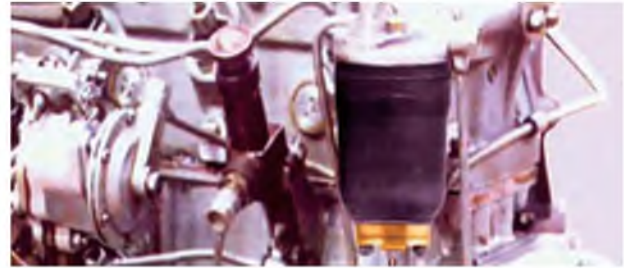
Паливний фільтр, який підігрівають
