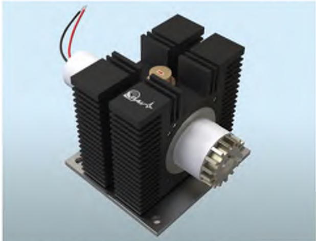
Магнетронний передавач на частоту 95 ГГц з вихідною імпульсною потужністю 1 кВт
