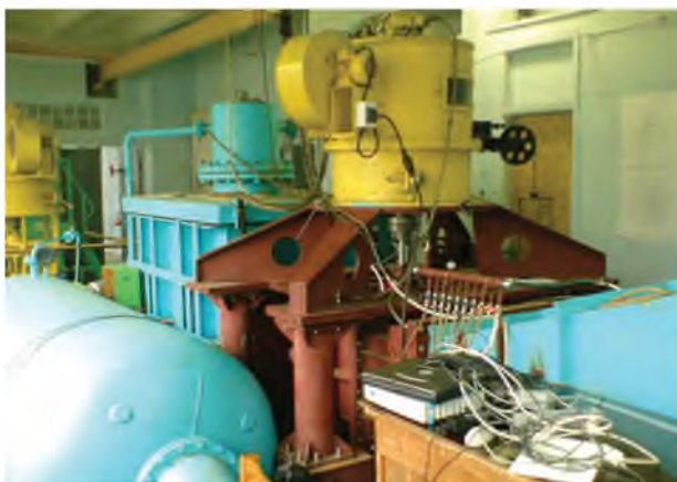
Моделний блок поворотно-лопатевої гідротурбіни ПЛ130, який встановлено на енергокавітаційному стенді ЕКС-15
