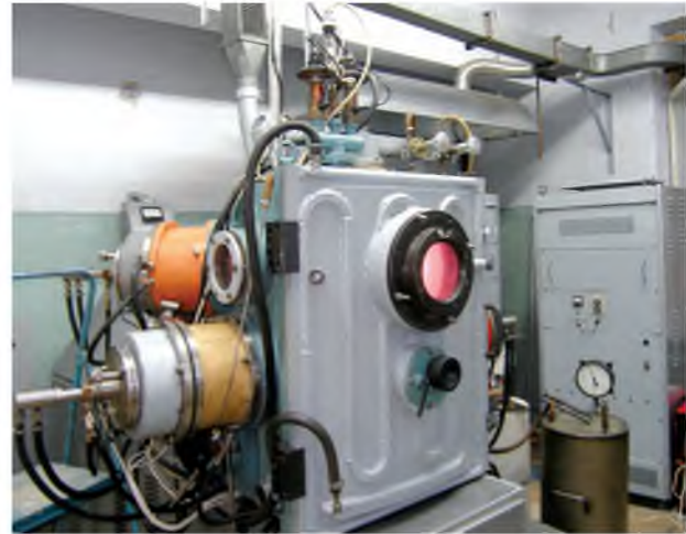
Іонно-плазмове обладнання для зміцнення поверхні
