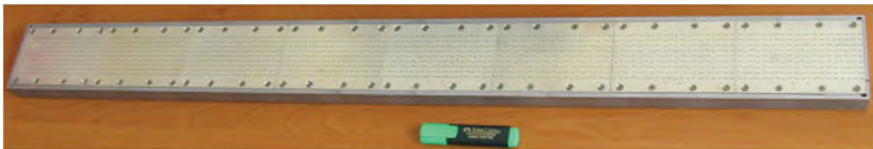
Хвильоводно-щілинна антена Ка-діапазону (36 дБі, 0,5 \times 10^\circ , РБП < -22 )
