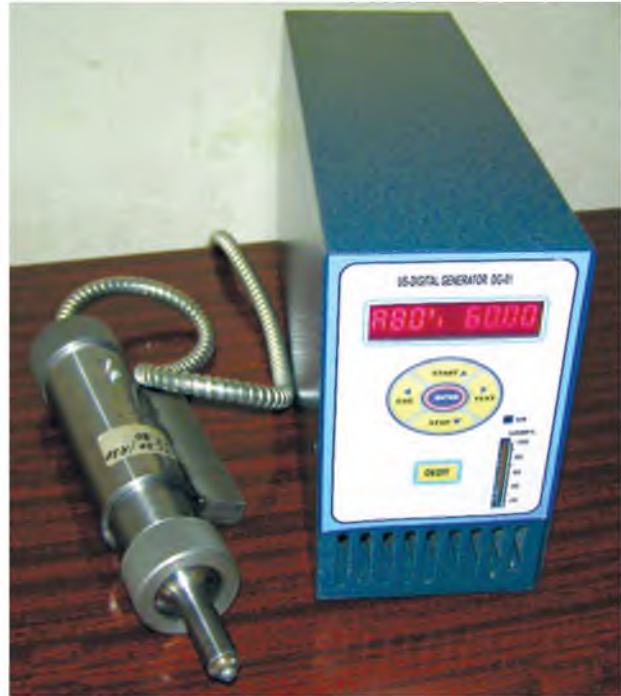
Обладнання для УЗФО (інструмент з твердосплавним наконечником, УЗ-генератор)
