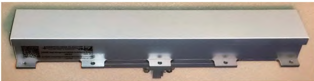
Рупорно-щілинна антена Х-діапазону (21 дБі, 5 \times 40^\circ , РБП < -20 , радом)
