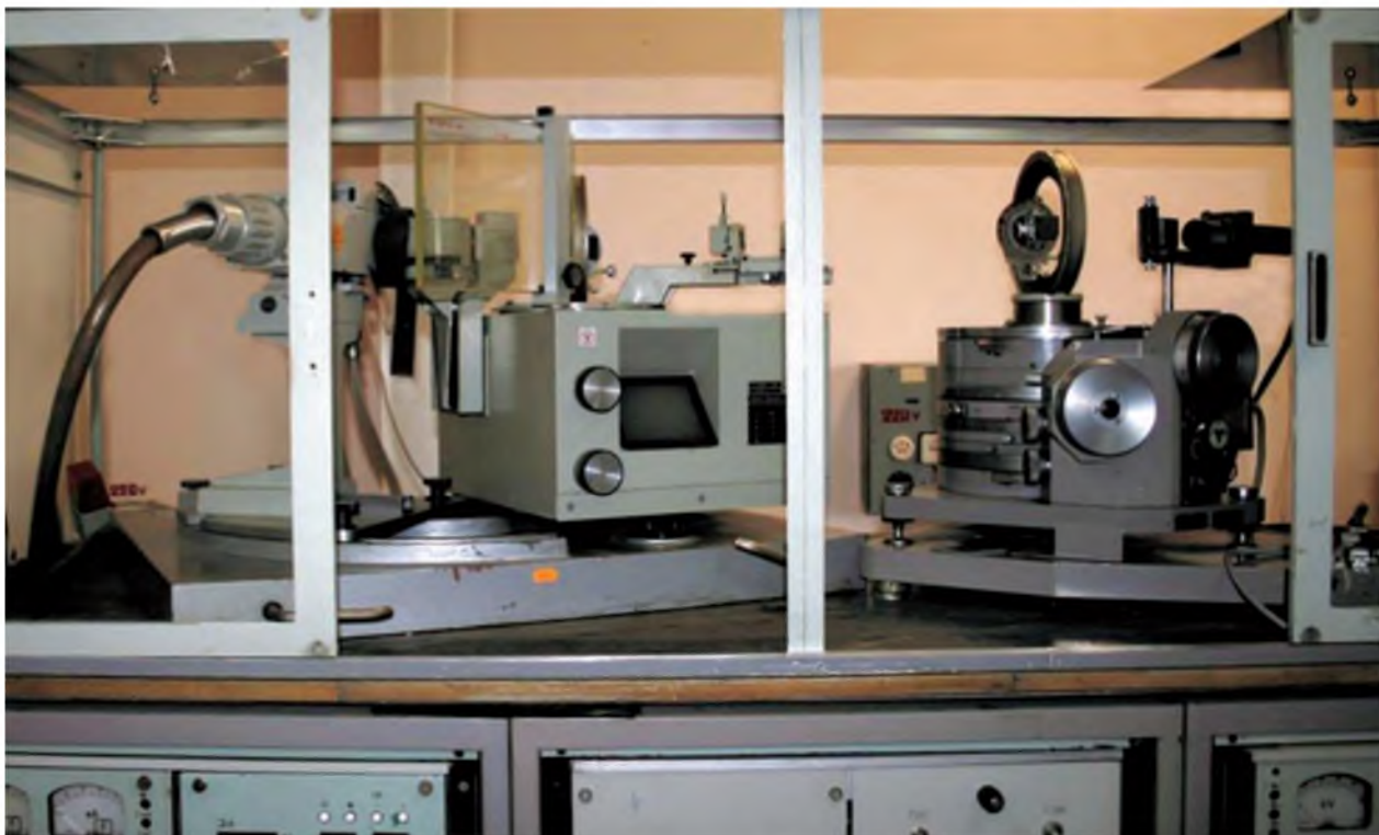
Прилад для неруйнівної діагностики монокристалів із дефектами декількох типів
