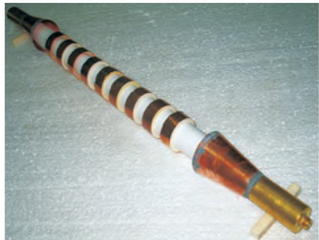
Дифракційна омні-антена для систем мобільного зв'язку
