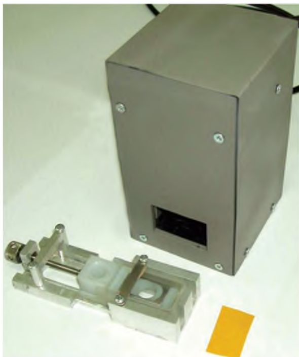
Оптоелектронний колориметричний течешукач летких газів «КД-3» разом з переносним блоком сенсора-маяка
