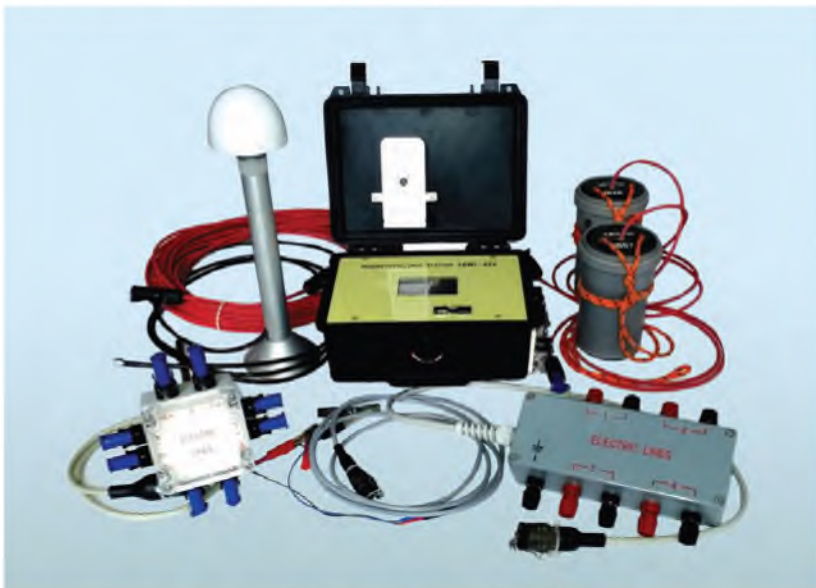
Блок електроніки магнітотелуричної станції ЛЕМІ-424 у комплекті з електродами та польовим устаткуванням
