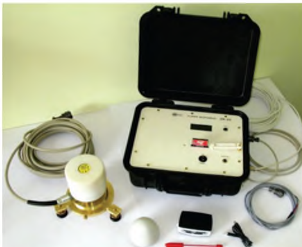
Зразковий ферозондовий магнітометр ЛЕМІ-025 в комплекті з ферозондовим давачем, GPS антеною та картридером
