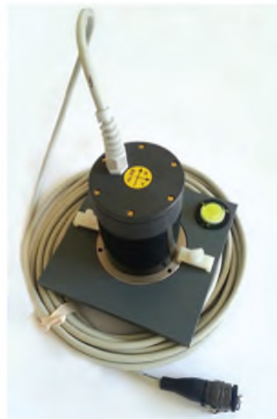
3-компонентний ферозондовий магнітометр магнітотелуричної станції ЛЕМІ-424
