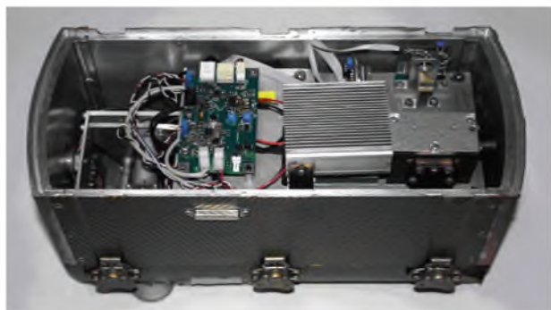
Вертикальний сейсмометр із цифровим лазерним інтерферометром
