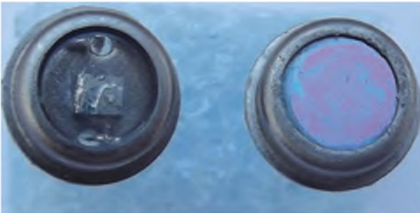
Прототипи неохолоджуваних InAs фотодіодів
