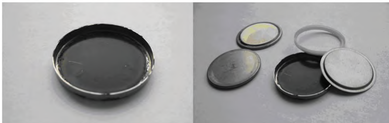
Плівка наноструктурованого композитного матеріалу (ліворуч), нанесена на внутрішню поверхню корпусу літій-іонного акумулятора електрохімічним способом, деталі акумулятора (праворуч)
