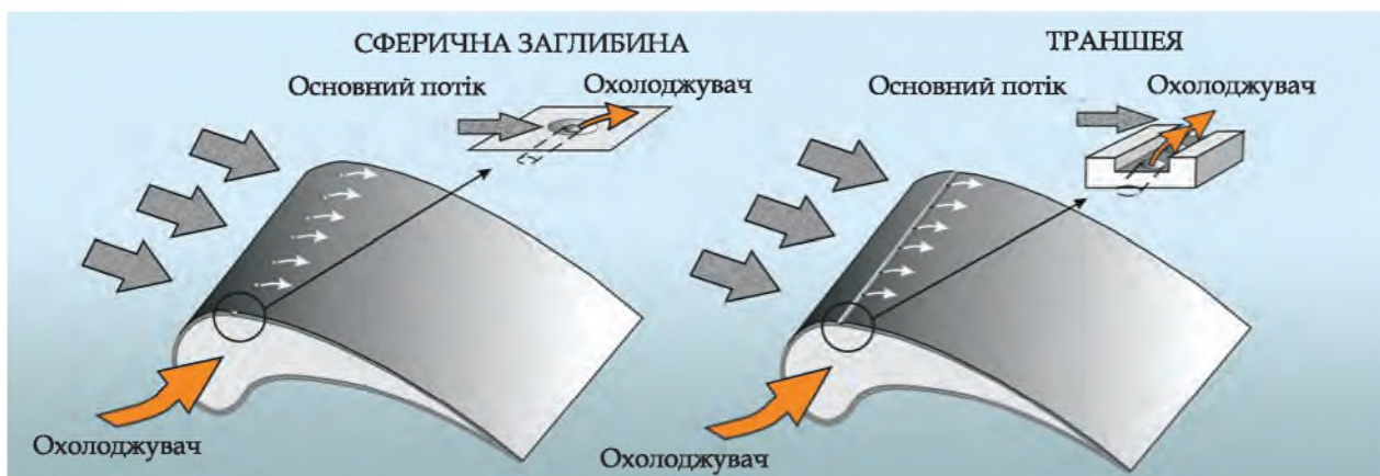
Схема плівкового охолодження лопатки газової турбіни з подачею повітря у заглибини сферичної форми і траншею
