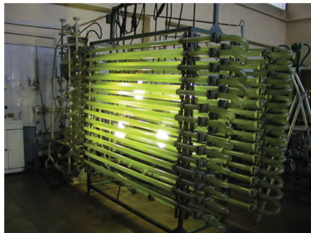
Лабораторний фотобіореактор закритого типу для культивування мікробіодоростей
