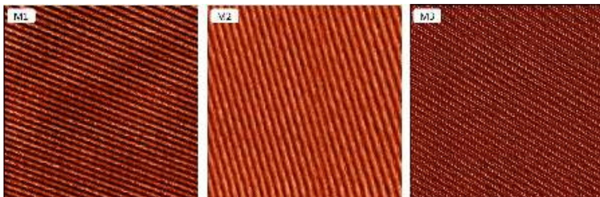
Рис. 4.2. Типові СТМ-зображення моношарів M1 , M2 та M3 на графіті. Площа сканування 75 \times 75 \text{ нм}^2 .
