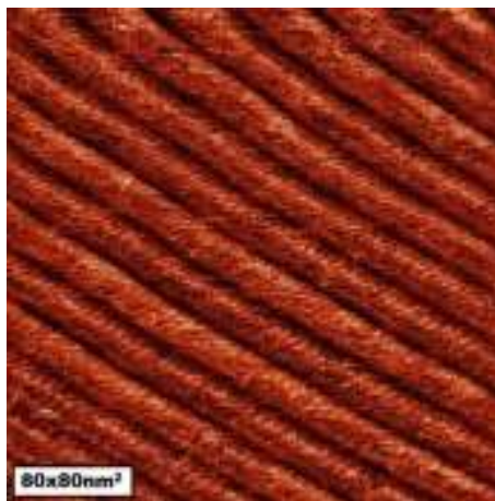
Рис. 3.13. СТМ-зображення бездефектної ділянки моношару C60, представленої на серії зображень рис. 3.12. Тунельні параметри: U_t=140\text{ мВ} , I_t=30\text{ нА} .
