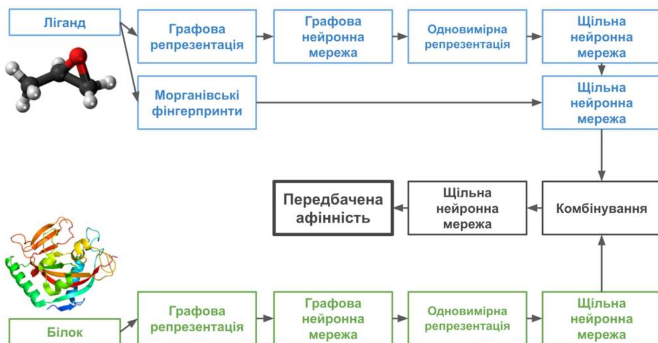
Рисунок 2.4. Загальна схема архітектури моделі 3DProtDTA.
